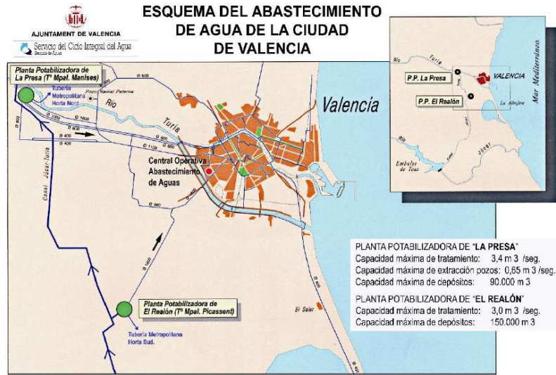
Figura 4. Esquema del abastecimiento de agua de la ciudad de Valencia
